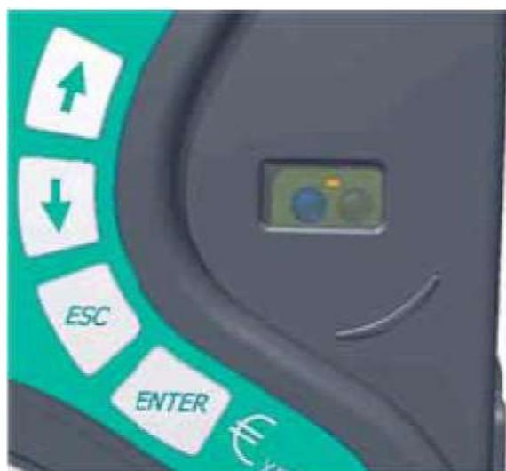
Inizialmente lo strumento si troverà in stato di stand-by e visualizzato mediante lampeggio di un led visibile nella finestrella della porta ottica quindi risulterà a prima vista spento.
